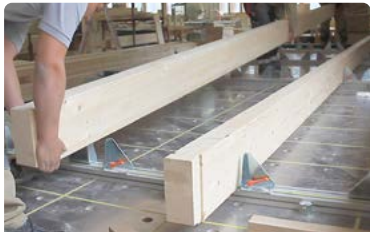
Doppelschiene Reiter-Paare fixieren alle Sparren im richtigen Abstand
