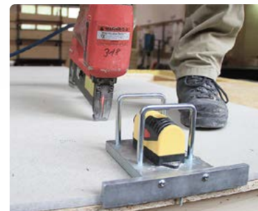
Laser Marker Effizientes Abnageln ohne vorheriges Anzeichnen mit Schlagschnur
