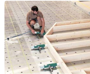
In den Winkel Element in den Winkel drücken oder längs spannen
