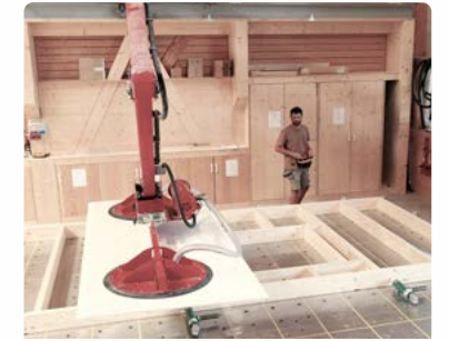
Teleskopischer Vakuumheber Platten und Schwellen aus der Ferne schnappen, mit intelligenten Assistenzfunktionen
