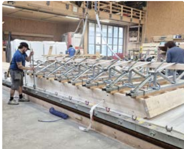
Pneumatische Pressvorrichtung Kastenelemente oder Rippendecken selber herstellen, statt zukaufen
