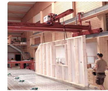
Wenden und Befördern Krantraverse immer gerüstet und vom Hallenkran unabhängig
