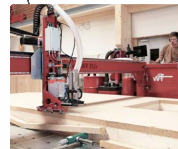
Multifunktionsportal Ausfräsen und Abklammern per Joystick, Touchscreen oder btl Maschinendaten aus dem CAD
