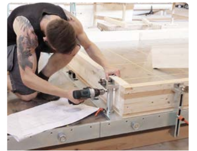
Tischunterteilung Zusätzliche Arbeitsstationen mit rechtem Winkel und flexiblen Anschlägen
