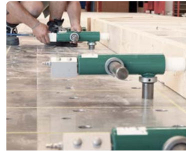
Pneumatisch Pressen Zylinder drücken auch ohne Luftzufuhr nach und halten das Element gespannt
