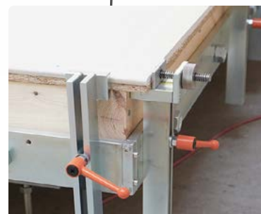
Plattenanschlag Plattenüberstand direkt auf dem Anschlag einstellen
