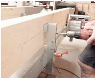
Präzise Ausrichten Von der Präzision des Tisches profitieren und verdreht Sparren an Anschläge ziehen
