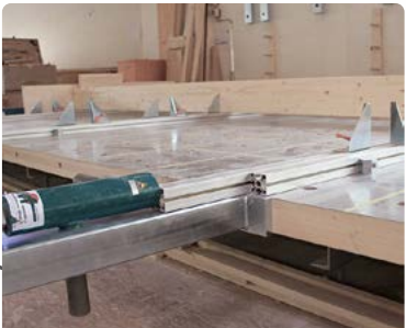
Einspannen Dank Pneumatikzylinder auch verdrehte Sparren gerade ausrichten
