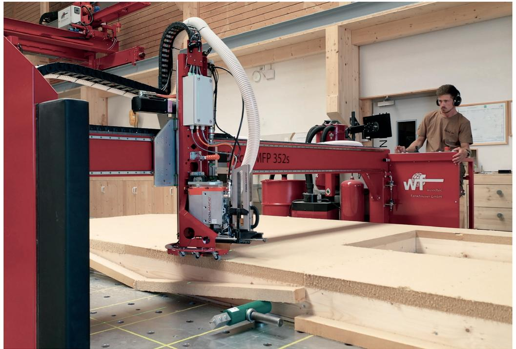
Dank einfachster Bedienung ist man beim Abklammern und Ausfräsen der Beplankung schnell, sauber und präzise unterwegs. Ein mühseliges Herumrutschen auf den Knien wird so zum attraktiven Arbeitsschritt.
