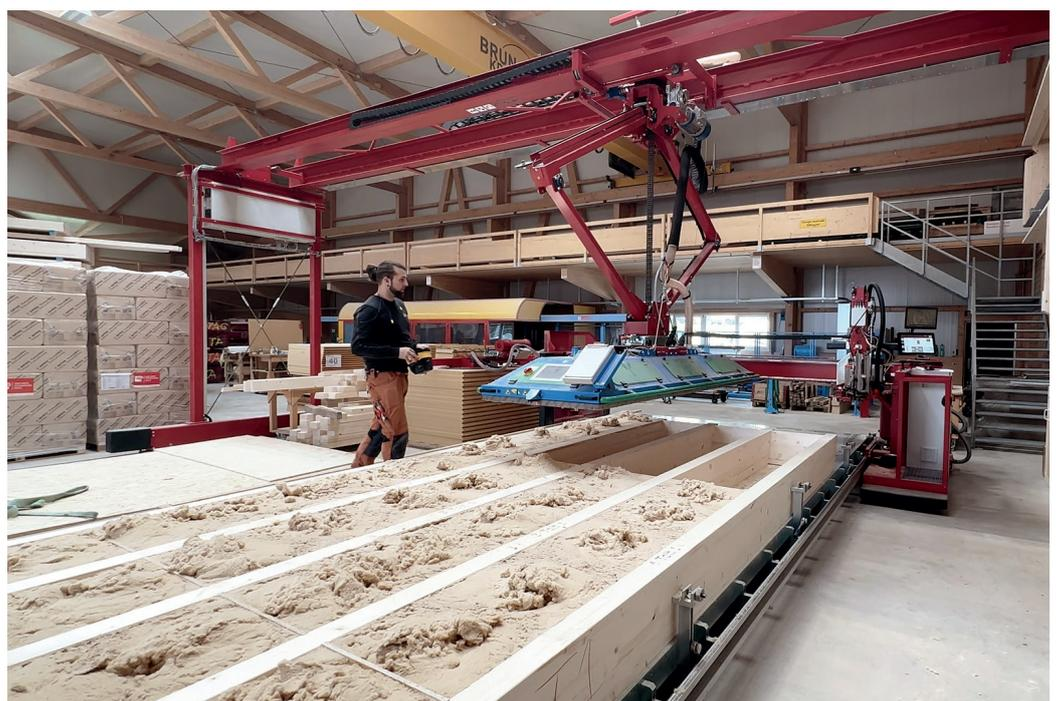
Viele zusätzliche Möglichkeiten wie Befördern der Einblasplatte oder Wenden der Elemente sind dank der ausgeklügelten Maschinenteknik der Anlage möglich.
