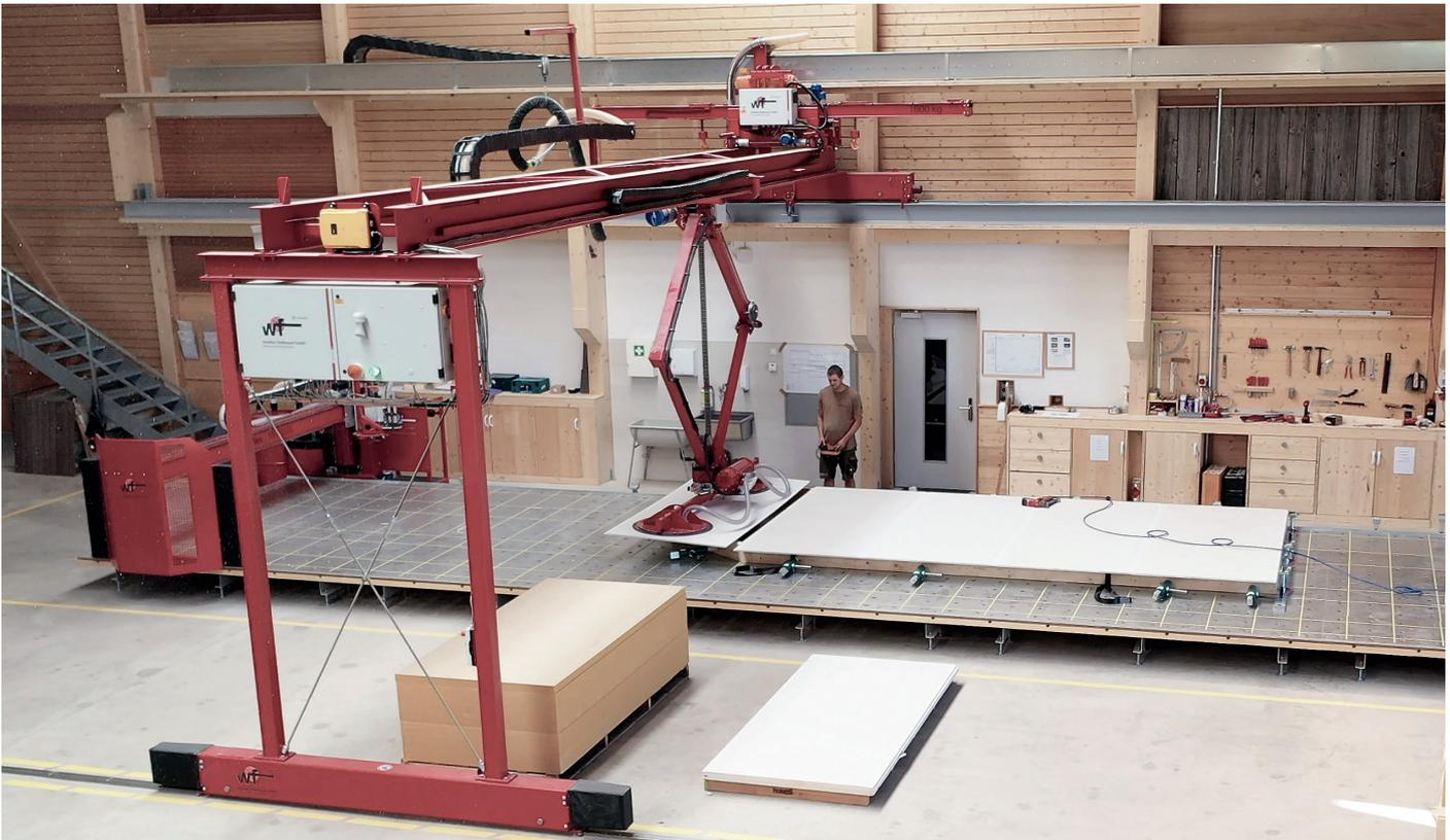
Materialhandling per Joysticks und automatischen Assistenzfunktionen: Dank teleskopischem Hubwerk ist der Bediener bei höchsten Geschwindigkeiten körperlich voll entlastet und deckt einen Arbeitsbereich von 10x22 m auch aus der Ferne ab.
