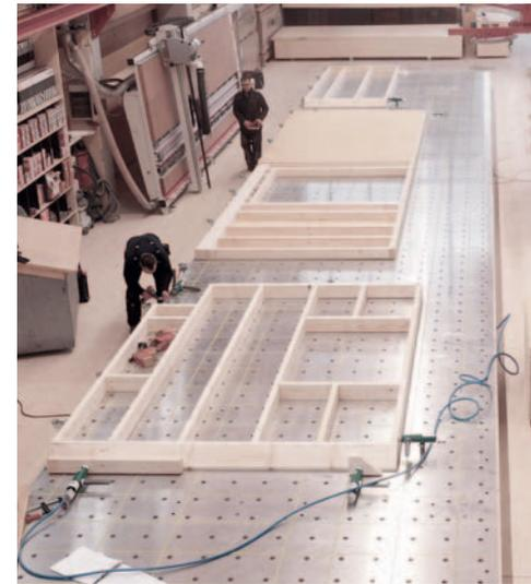
▲ Zusätzlich zu einer automatisierten Anlage, setzte man bei der Modernisierung der zweiten Produktionshalle bei der Holzbau Bendler GmbH auf eine flexible Fertigungsanlage mit 20 m langem Montagetisch und teleskopischem Handlingkran von Woodtec
