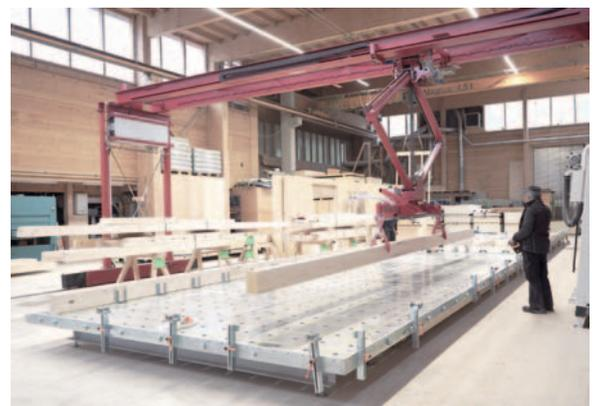
▲ Mit Balkengreifern oder Saugtellern bestückt, dient der Handlingkran auch zum Befördern von schweren Schwellen
