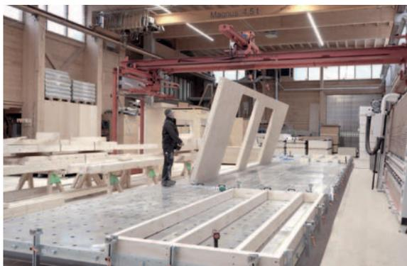
▲ Zwei Kranhaken mit verstellbarem Abstand zum schnellen Wenden oder Transportieren der Elemente bringen einen effizienteren Fluss in den Produktionsablauf
