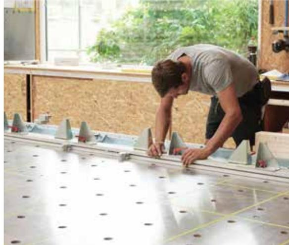
Die Reiter auf der Schiene werden anhand eines integrierten Maßbands nach Plan positioniert und vereinfachen das Ausrichten der Ständer
