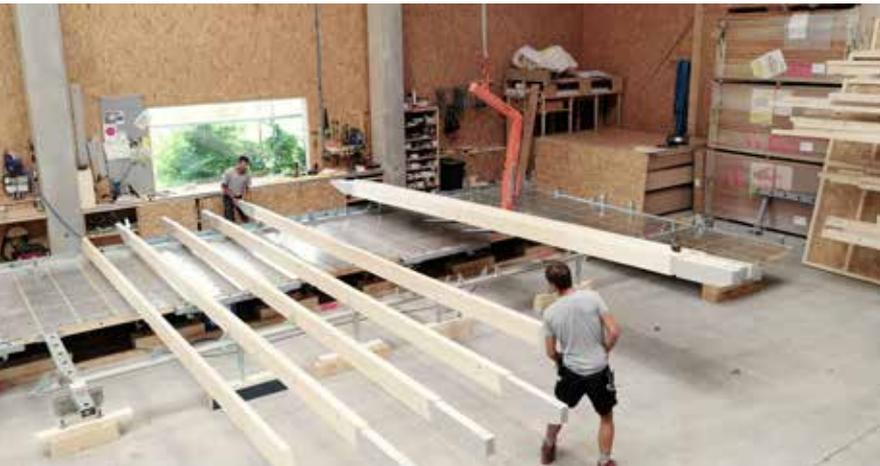
**Auslegen der Sparren ohne Maßbänder: Die Reiter der Dachvorrichtung geben die genaue Position automatisch vor**
