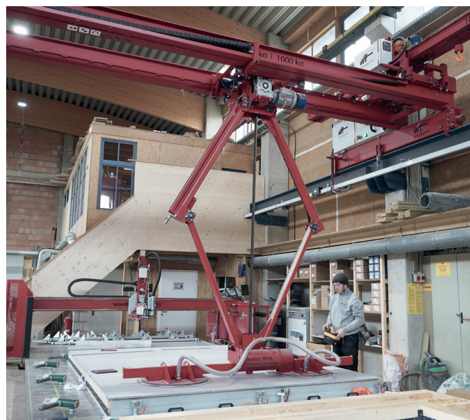
Das teleskopische Scherenhubwerk erlaubt nicht nur hohe Fahrgeschwindigkeiten, sondern dank stufenlosen Joysticks auch genaues Positionieren. Gerade bei schweren Fermacell-Platten, die sich nur schlecht verrutschen lassen, eine grosse Erleichterung.
