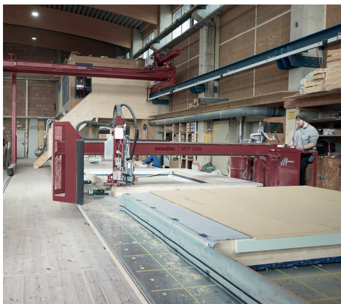
Das Multifunktionsportal unterstützt den Mann beim Abklammern und Ausfräsen der Beplankung mit vielen automatischen Routinen. Der Bediener kann die gewünschten Bearbeitungsschritte per Joystick und Touchscreen steuern und hat so immer maximale Freiheit ohne Datenaufbereitung vorab.
