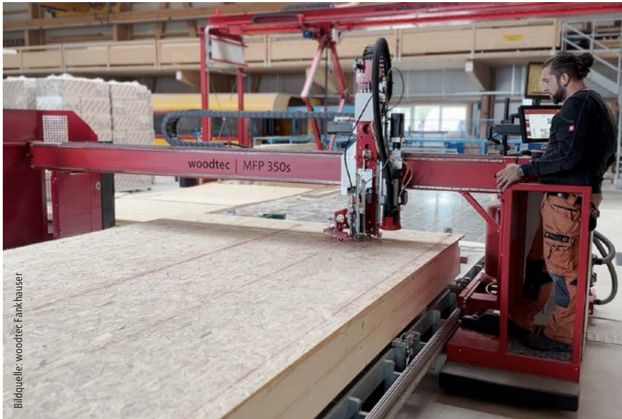
Nicht mehr auf den Knien herumrutschen: Dank des MFP 350 ist das Abklammern und Ausschneiden der Beplankung wieder attraktiv. Der Vorgang wird vom Benutzer über Joystick und Touchscreen gesteuert und benötigt im Gegensatz zu traditionellen CNC-Brücken keine vorherige Datenaufbereitung.
