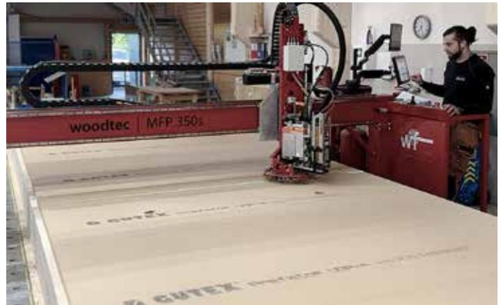
**Benutzergesteuerte Bedienung ohne Mehraufwand: Die Planausgabe erfolgt auf Papier oder direkt auf das Tablet des Multifunktionsportals. Der Mitarbeiter gibt per Joystick und Touchscreen vor, wo die Maschine abklammern soll**
