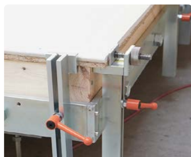
Butée de revêtement Régler le débord du panneau directement sur la butée
