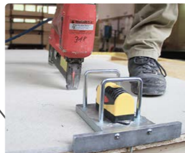
Marqueur Laser Agrafage efficace sans traçage ni marquage préalable
