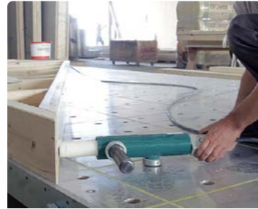
Petit vérin pneumatique Même déconnectés les vérins gardent leur poussée de 330 kg
