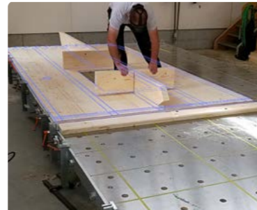
Bauteile auslegen Bauteile und zugehörige Nummern und Masse werden in Echtgrösse angezeigt
