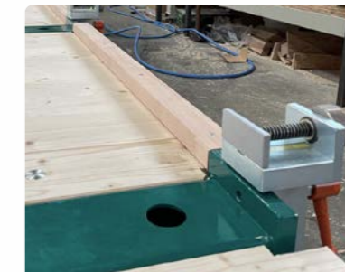
Rail à trous pro Rail à trous de 3.3 m avec butée pour débords de panneaux
