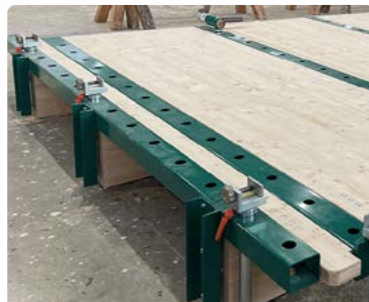
Butée latérale pro Rail à trous bas avec des butées encastrables pour aligner montants (et panneaux) à fleur ou avec débords.
