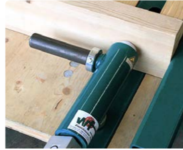
Vérins pneumatiques Equerrage et serrage de l'ossature, pour un assemblage plus rapide
