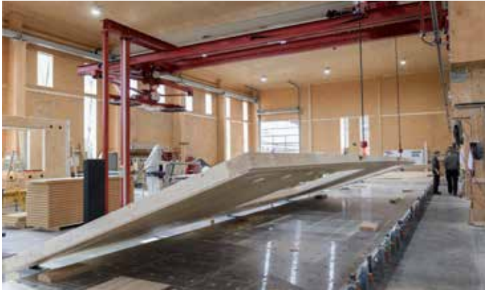
Mit der Wende- und Transportvorrichtung des Krans können Elemente gewendet werden. Der Hakenabstand wird per Fernsteuerung geregelt, was Rüstzeiten vermeidet
