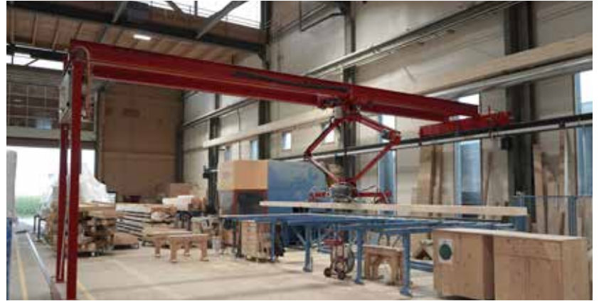
Speziell auf Stabmaterial ausgelegte Sauger und Vakuumpumpen erlauben das Be- und Entladen von Abbundanlagen. Dabei sorgt das schwingungssteife Teleskophubwerk für hohe Taktzeiten und kurze Hubzyklen
