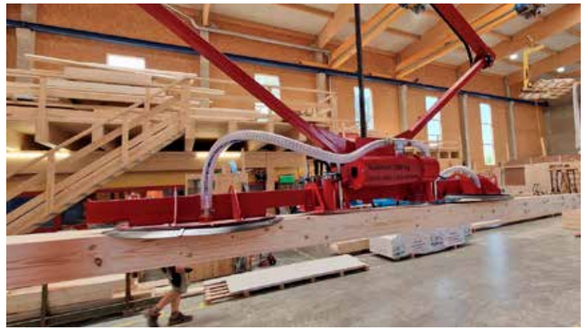
Weitere Module sollen den Handlingkran noch multifunktionaler machen, etwa Schraubgreifer für nicht per Vakuum saugbares Material wie Weichfaserplatten oder Dübelholz
