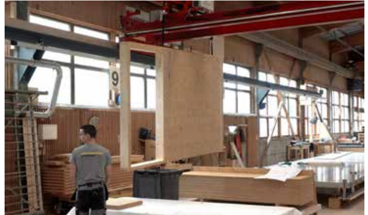
Das „WT“- Zusatzmodul zum „Handlingkran Pro“ erlaubt es, die Holzelemente zu einer anderen Station zu transportieren – auch über andere Elemente oder Materialstapel hinweg
