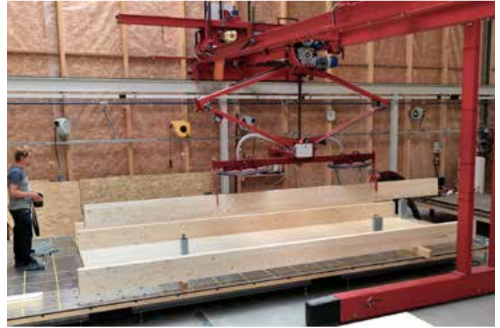
Mit Balkengreifern, die sich in den Kran einklinken lassen, können neben Plattenmaterial auch Balken, Schwellen und Träger transportiert werden
