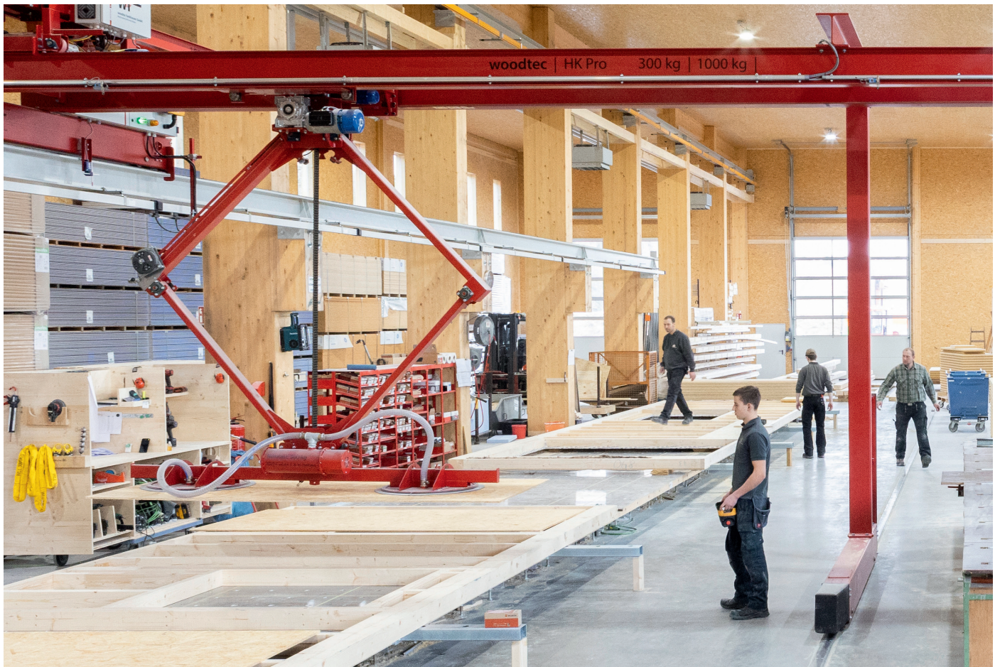
Der Handlingkran mit Vakuumheber entlastet die Mitarbeiter beim Heben von schweren Platten oder Balken und ermöglicht einem Arbeiter sein Element allein zu fertigen, auch wenn der Hallenkran besetzt ist. Das teleskopische Scherenhubwerk ermöglicht schnellere Hubzyklen und kollaborative Bedienung wie z. B. Autohoming.
