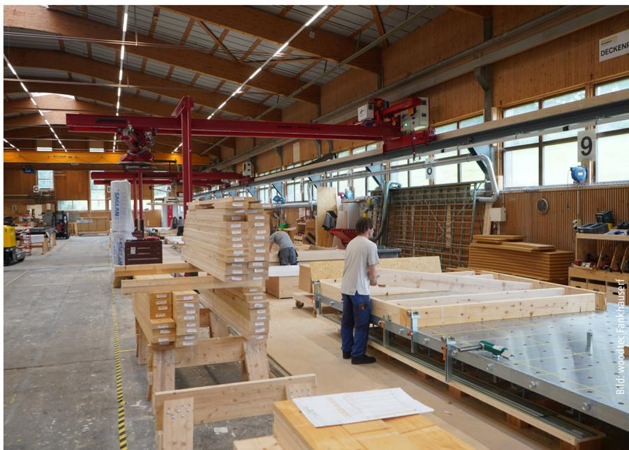
Beim Holzrahmenbau kann allein bei den Wänden bei einem Einfamilienhaus ca. 60 bis 70 Prozent an Holz eingespart werden, wenn man von einer durchschnittlichen Wandstärke von 100 mm in Massivholz ausgeht.
