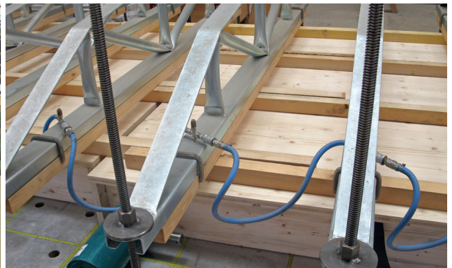
Dank der Klebstoffverbindung ist die Holzwerkstoffplatte auf der Unterseite dieses Bauteils nicht nur tragend, sondern auch in Sichtqualität.
