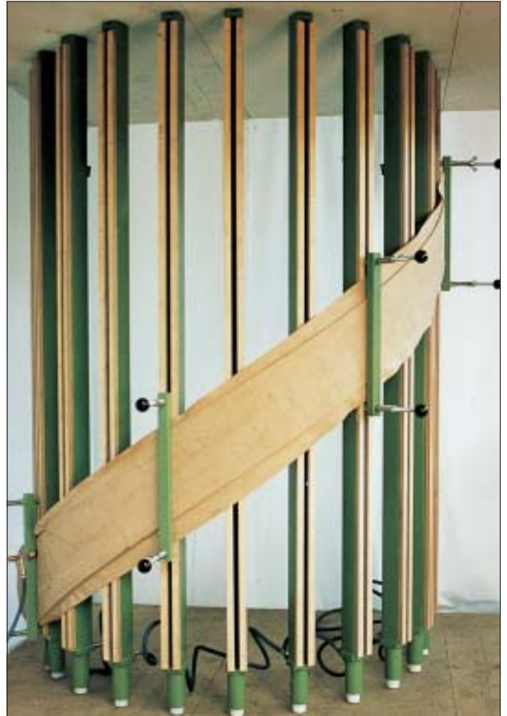
Wandwange aus MDF-Platten 5mm. Senkellänge des Rohlings ca. 1.3 m.
